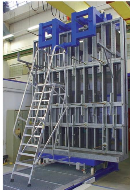
**Bild 4** Kippbarer Großprüfstand für Verfüllversuche [22]
